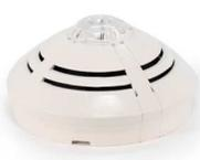
Multisensormelder mit zwei integrierten optischen Rauchsensoren mit unterschiedlichen Streulichtwinkeln sowie zusätzlicher Thermomeldersensor Auswertung zur Erkennung von Schmelbränden bis hin zu offenen Bränden mit gleichmäßigem Ansprechverhalten. Vergleich der Rauchsensoren signale zur Rauchklassifizierung und Reduzierung von Täuschungsalarmen, beispielsweise durch Wasserdampf oder Staub.
