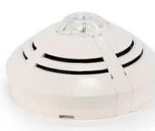
Streulicht-Rauchmelder zur sicheren Früherkennung von Bränden. Prozessanalogmelder mit dezentraler Intelligenz, Eigenfunktionskontrolle, Notredundanz, Alarm- und Betriebsdatenspeicherung, Alarmanzeige, Softadressierung und separater Betriebsanzeige. Der Leitungstrenner ist im Melder integriert. Eine Melderparallelanzeige ist zusätzlich anschließbar.
